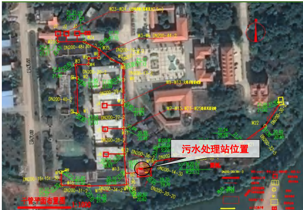
图 4.2-3 污水处理站及管网图
