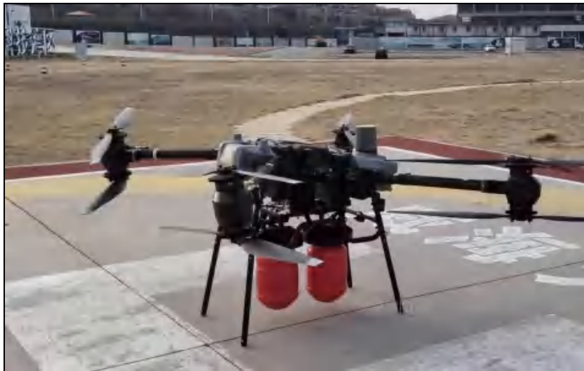
图 5.3-155 挂载灭火弹的中型运载无人机
